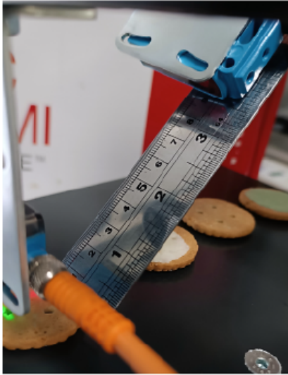
Distancia Sensor Autoreflex FGS: 90 mm
