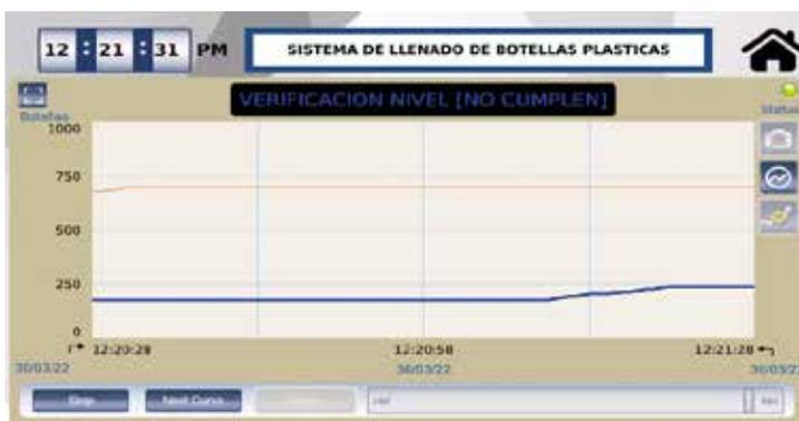
La distancia para esta aplicación fue una variable fundamental; estos datos son enviados y recibidos por medio inalámbrico a una distancia de 7 metros sin obstáculos importantes. El PLC como Scanner Ethernet/IP consulta los datos del adaptador IO-Link y los muestra en una interfaz gráfica intuitiva para los usuarios; de esta forma se logró la supervisión remota de los niveles de llenado.
