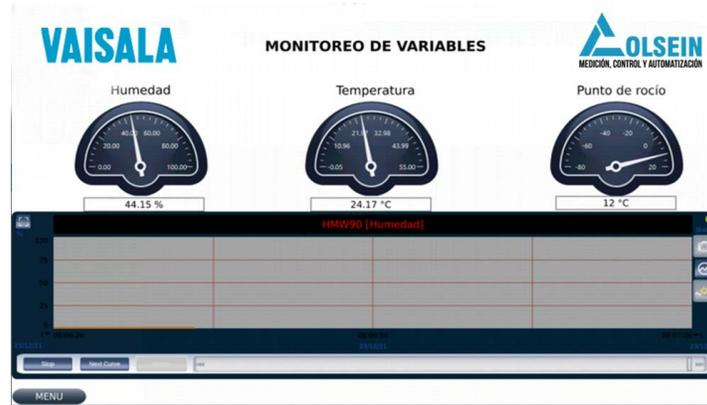
En la pantalla principal se diseñó un sistema de control manual y automático; para que el operario o las personas de mantenimiento tengan la facilidad de cambiar según el uso que se le vaya realizar al sistema de refrigeración. También cuenta con un sistema de visualización y monitoreo de las diferentes variables que se están leyendo del PLC.
