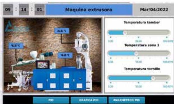
Se desarrolló una interfaz que permite verificar los valores de temperatura en los puntos específicos de la extrusora para que el operario pueda manipular la variable de "Set point", cuando la receta o el proceso lo requiera
