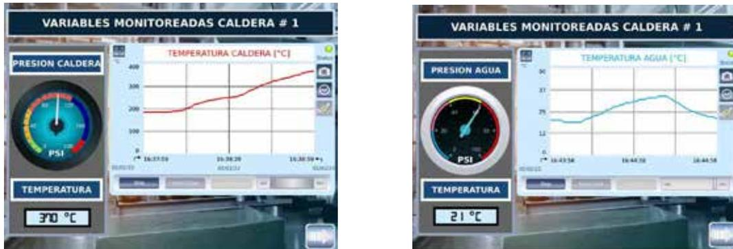
Como se puede evidenciar en las imágenes anteriores, tenemos dos tendencias en tiempo real las cuales indican la variación de la temperatura en función del tiempo. Se tiene dos manómetros analógicos que entregan un valor en PSI de la presión de la caldera y el suministro de agua, el operador se puede encontrar en otra área y aun así puede monitorear su proceso.
