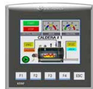
El PLC Vision V350 fue el encargado de ejecutar todas las acciones que representan el funcionamiento automático de las calderas, el sistema de monitoreo consta de dos transductores de presión instalados con una señal de salida de 4-20 mA, se tienen dos PT-100 las cuales entregan la temperatura del agua de suministro de caldera y la de la cámara de vapor seco. Todas las señales son llevadas directamente al controlador para que así mismo fueran procesadas.
